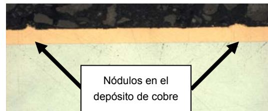
Figura 1.- Nódulos en el depósito de cobre alcalino sobre zamak.
