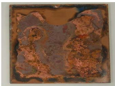
Figura 2. Corrosión del cobre
