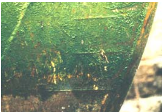
Casco de un barco mostrando el proceso de biocorrosión provocado por el alga verde Enteromorpha , (foto por cortesía Dr. M.E. Callow).
